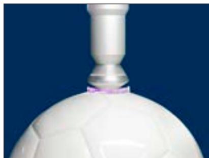
**Openair-Plasma-Rotationsdüsen arbeiten mit Geschwindigkeiten von 2.700 Umdrehungen in der Minute. Das seitlich des violetten Lichtbogens ausströmende (nicht sichtbare) Plasma bewirkt eine hohe Aktivierung der Balloberfläche und in Folge ihre homogene Benetzbarkeit. (Bild: Heidelberger Druckmaschinen AG)**
