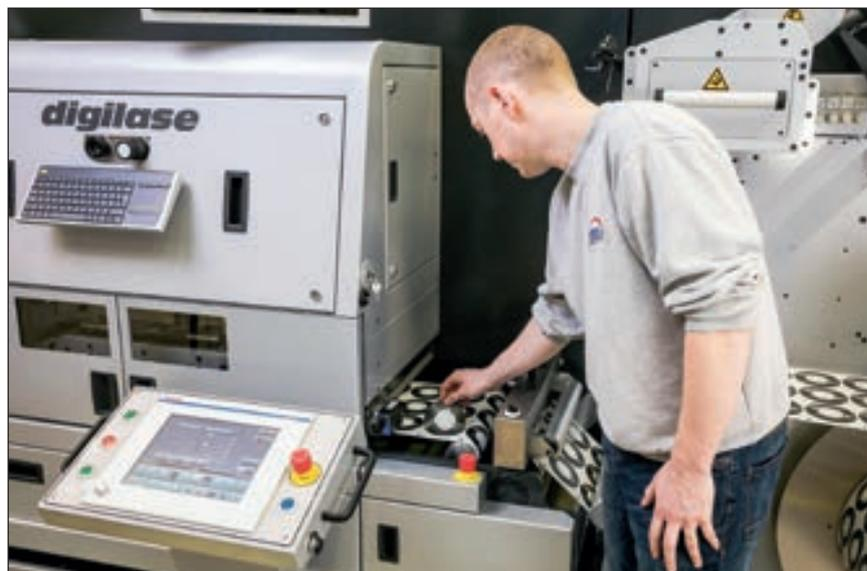
**Die neue Laserstanze Digilase S3 sorgt für eine hochpräzise Auszustanzung. Um optimale Resultate zu erzielen, sollte die Dicke der Klebstoffschicht des Haftmaterials nur sehr wenig schwanken.**
