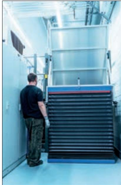
*Der Plattenlift befördert die Plattenwagen auf die Galerieebene. Von dort müssen die Druckplatten nur noch in die einzelnen Werke verteilt werden.*
