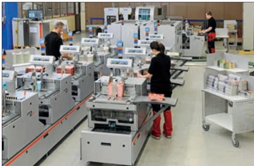
*Durch den Doppelstrang bietet jede One2Out-Anlage maximale Flexibilität: So lassen sich bei der Beilagen-in-Beilagen-Verarbeitung bis zu 40.000 Exemplare/h realisieren.*
